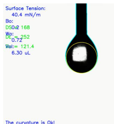
شکل ۴- اندازه‌گیری کشش سطحی براساس آنالیز شکل قطره
