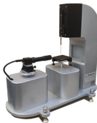
شکل ۳- دستگاه اندازه‌گیری کشش سطحی و زاویه تماس Jikan CAG-20
