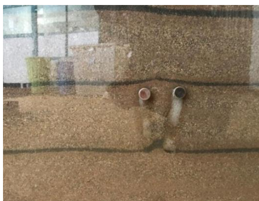
شکل ۸- تصویر آهن‌رباهای قرار گرفته روی شیشه متناظر با آهن‌رباهای نصب شده بر روی مهار
