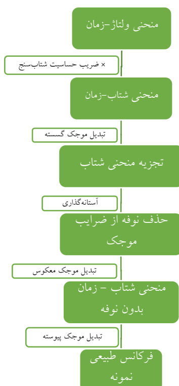
شکل ۶- فرآیند استخراج فرکانس طبیعی نمونه از سیگنال شتاب سنج.
