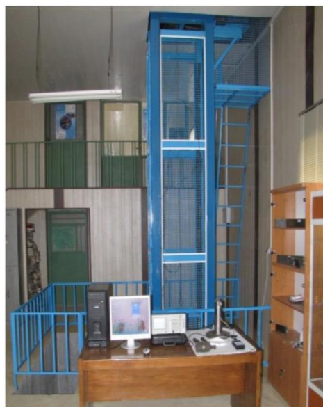
شکل ۱- دستگاه ضربه سقوطی مجهز به شتاب‌سنج در آزمایشگاه ضربه دانشگاه بیرجند.
